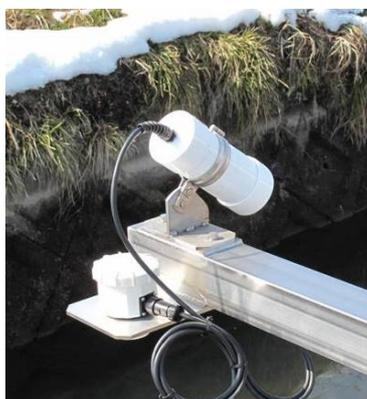
農業水路用流量計 (水位、流速計)
