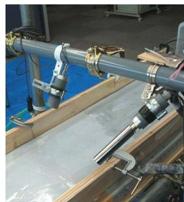
電波式流速計 (実験水路用)
