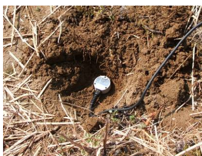
地中音圧計 （センサ埋設前）
