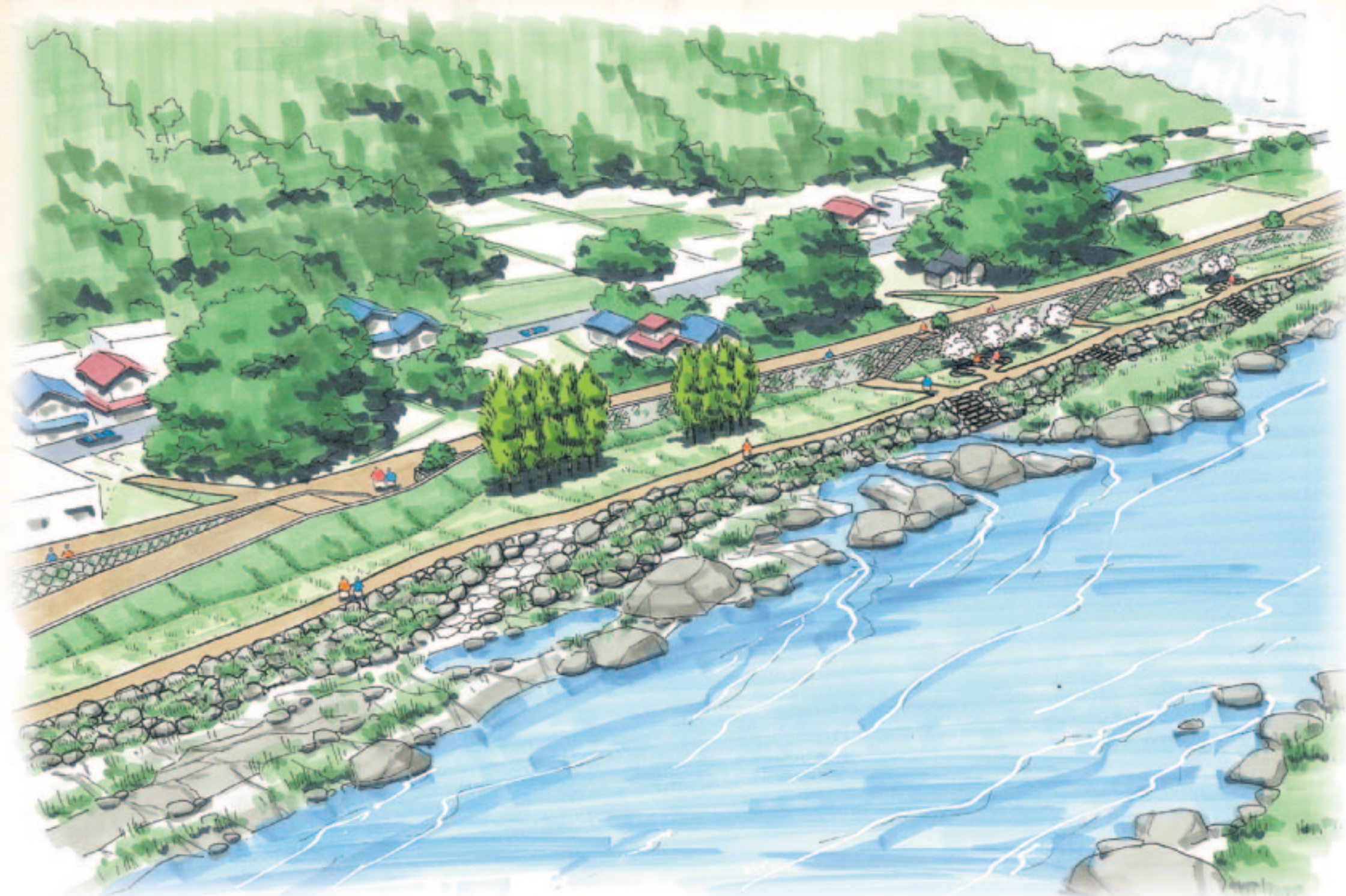
山国川青地区(青の洞門地区)護岸整備
