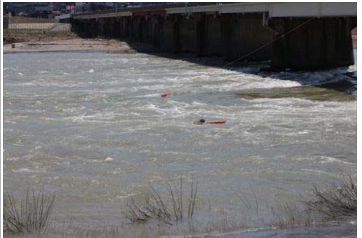
写真-4 現地試験の実施状況（ADCP） （2015年4月 信濃川旭橋）
