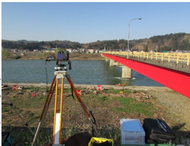
写真-8 現地試験の実施状況（STIV） （2014年4月 魚野川根小屋橋）
