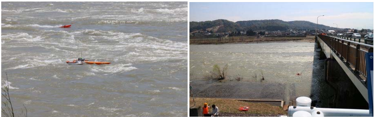
写真-7 ADCPによる横断流速観測の状況（2015/4/23 信濃川旭橋）
