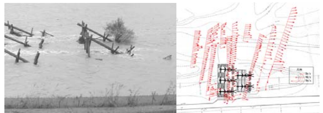
LSPIVを用いて水制工の効果確認を行った事例
