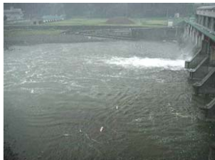
ダム下流の流況観測にLSPIVを適用した事例
