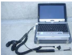
衝撃弾性波による劣化深さ調査
