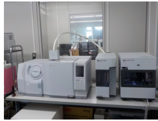
ガスクロマトグラフ質量分析装置 (カビ臭物質等を測定)
