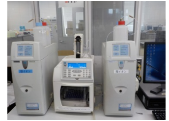
イオンクロマトグラフ (イオン成分を測定)
