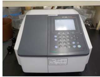
吸光光度分析装置 (窒素やリンを測定)
