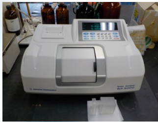
濁度計 (水中の濁度を測定)
