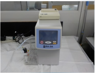
還元気化原子吸光光度計 (水銀を測定)
