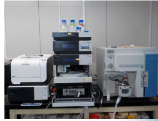
液体クロマトグラフマシ型質量分析装置 (界面活性剤を測定)
