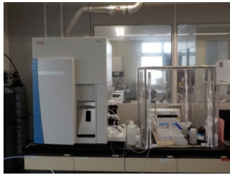
誘導結合プラズマ質量分析装置 (ヒ素等の重金属類を測定)
