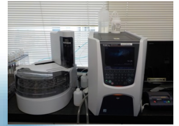
全有機態炭素計 (有機物量を測定)
