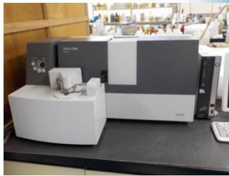
レーザー回折粒子径分布測定装置 (粒度分布の測定(75μm以下))
