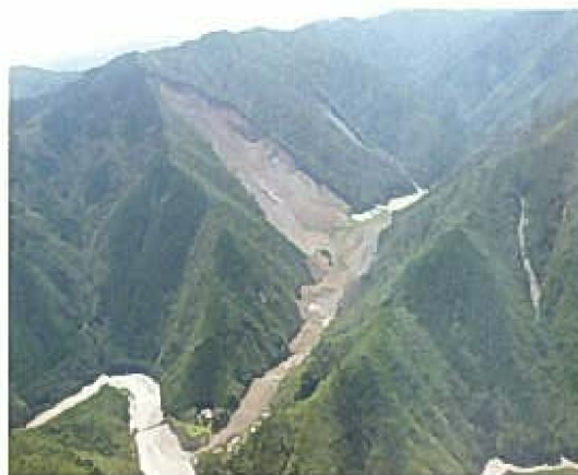
奈良県五條市大塔町赤谷地区に発生した河道閉塞 (天然ダム)
