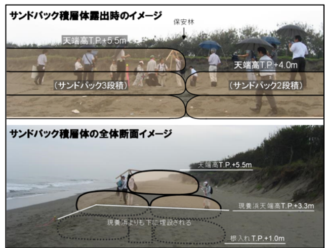
写真-2 設計時におけるサンドバック天端高の比較検討状況
