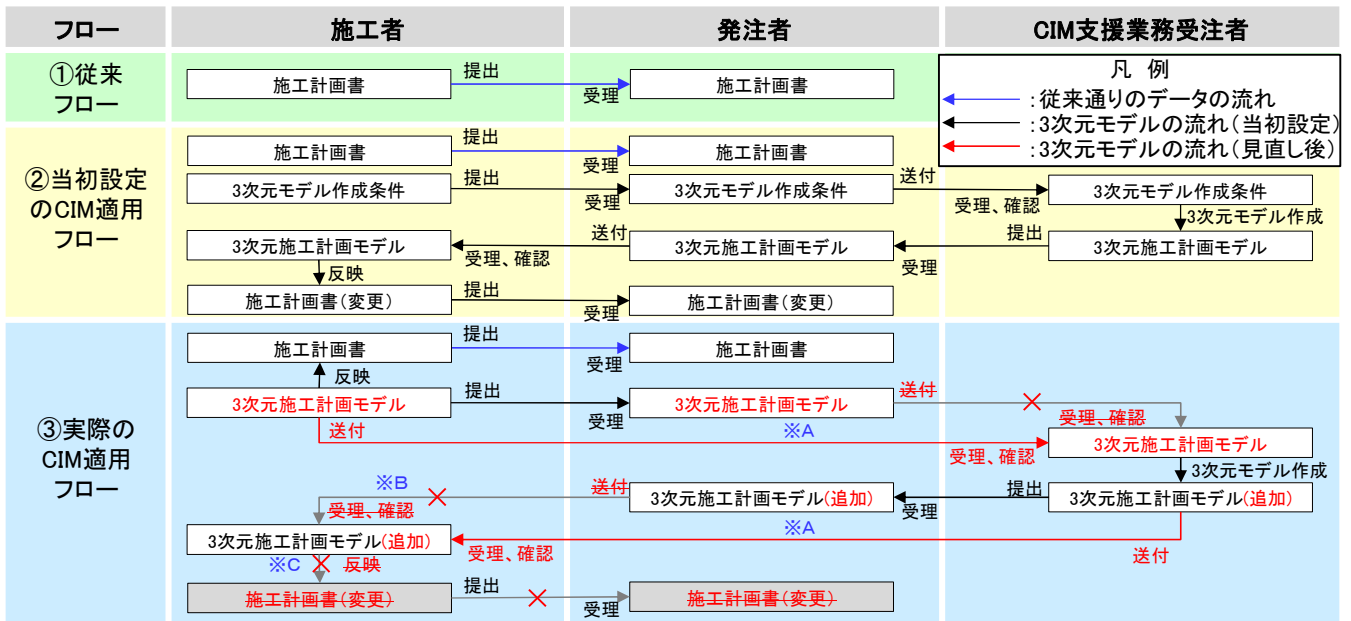
図-2 施工計画書作成段階におけるフローの整理結果
