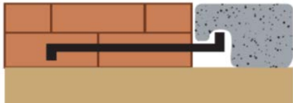
図-1 ズレ止め金具 ズレ止め金具は笠石に開けられた穴に差し込まれていた
