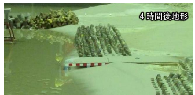
図-8 ケース4 突堤移設 実験結果
