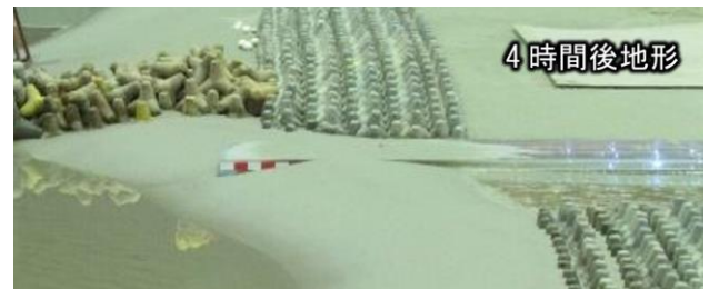
図-7 ケース3 吐口背後掘削 実験結果
