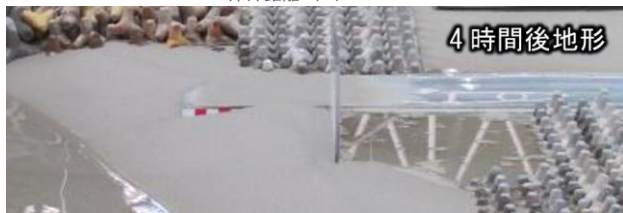
図-6 ケース2 反射壁設置 実験結果
