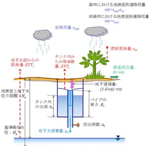
図-6 地下水涵養モデルの原理
