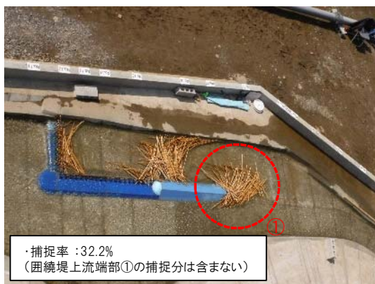
図-18 最終形状での捕捉状況 (1/30計画流量、均等投入)
