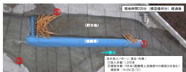
図-8 原案実験での流木捕捉状況 (H29.7被災流量)
