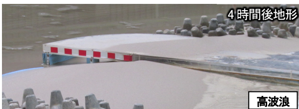
図-5 ケース7(突堤撤去+吐口背後掘削) 実験結果
