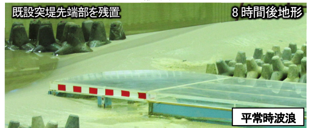
図-6 ケース8(突堤一部残置+吐口背後掘削) 実験結果
