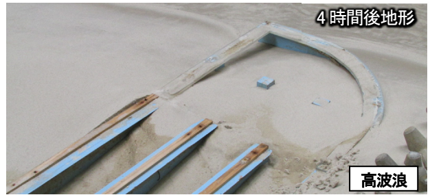
写真-5 ケース7(突堤撤去+吐口背後掘削) 樋管内部の状況
