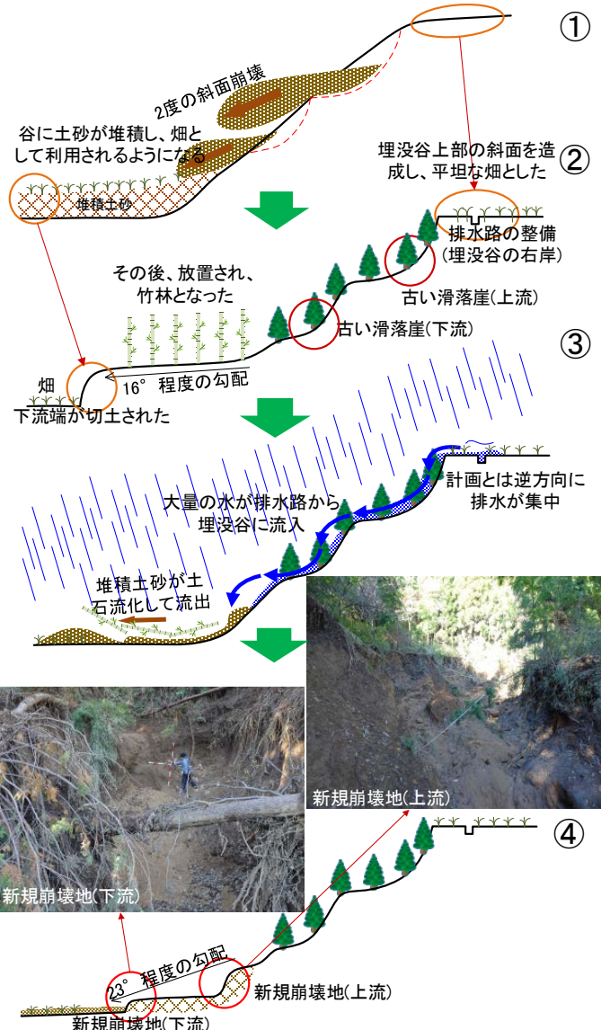
図5 当該箇所での土石流発生メカニズム
