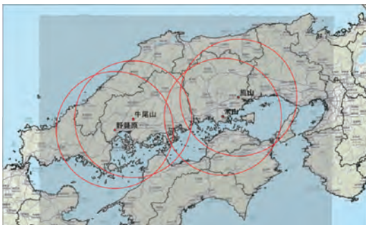
図-6 XバンドMPレーダの位置関係 Fig. 6 Positional relation of X-band MP radars.
