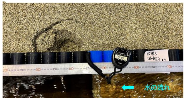
図-8 段落ち堰における吸出し後の護岸の様子
