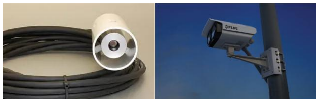
(a) 放射温度計 (b) IRカメラ 図-1 利用した水温計測機器
