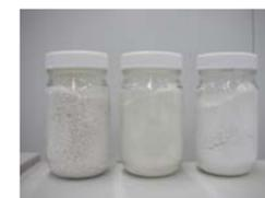
海水から摂れるマグネシウムを主成分とする製品です。実験では、植物プランクトンを吸着して、底に沈める作用や泥からリンや窒素が溶け出すのを抑える作用を利用します。
